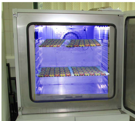
شکل ۱- قراردادن نمونه‌ها در دستگاه Binder در شرایط رطوبت، دما و نور جهت پیرسازی (نگارنده، خرداد ۱۳۹۵)
