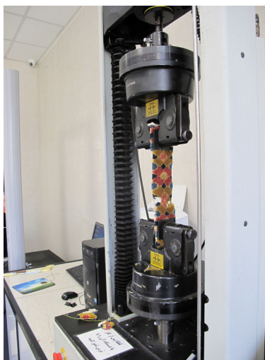
شکل ۵- استحکام کششی بر روی نمونه‌ها (نگارنده، ۱۳۹۵)
