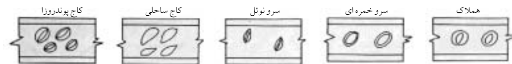
شکل ۲: انواع منغذها در پره‌های چوبی سوزنی برگان (۸)
