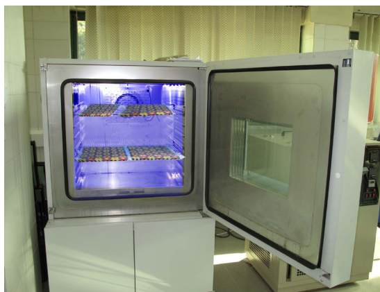
شکل ۳- نور دهی نمونه‌های پیرسازی شده با لامپ UVA-B (نگارنده، ۱۳۹۵)
